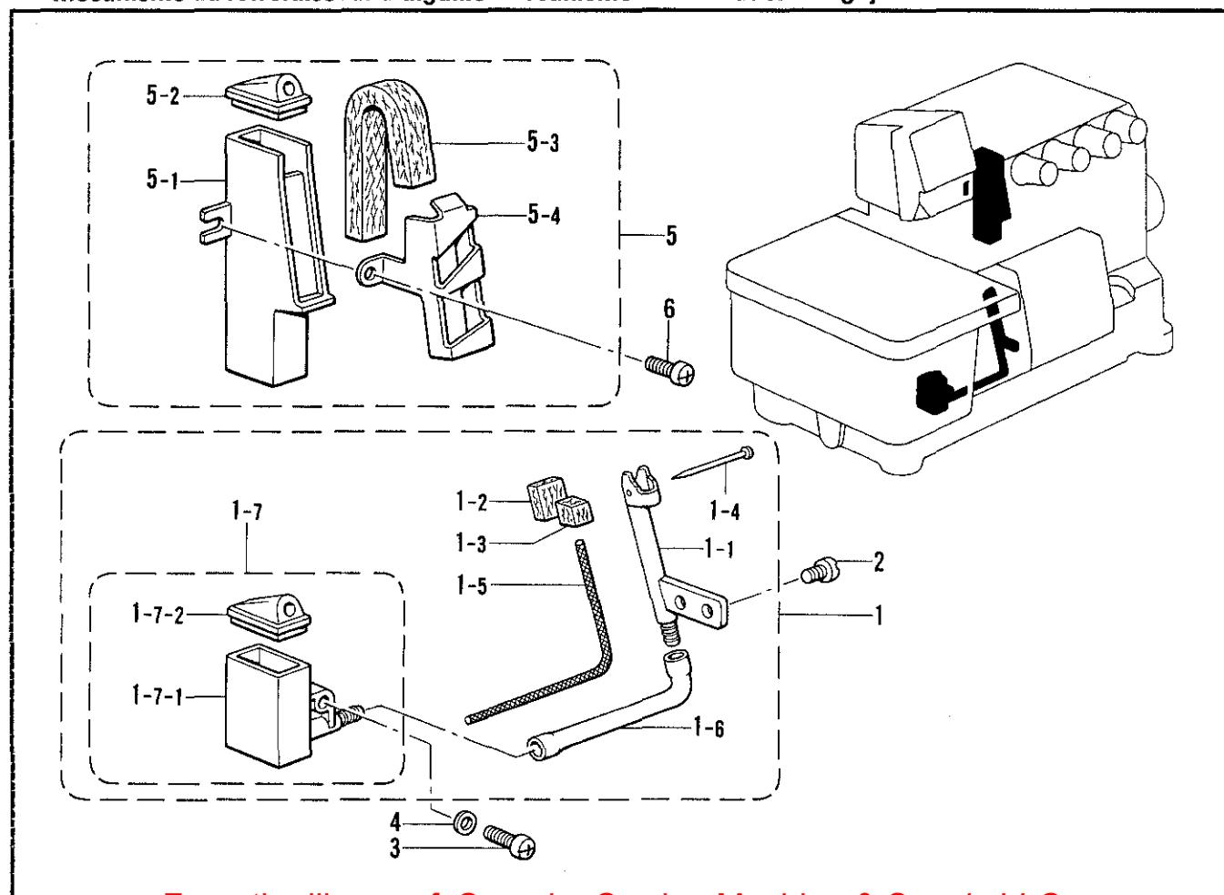
L. 給油・潤滑関係/Lubrication/Schmierung/
