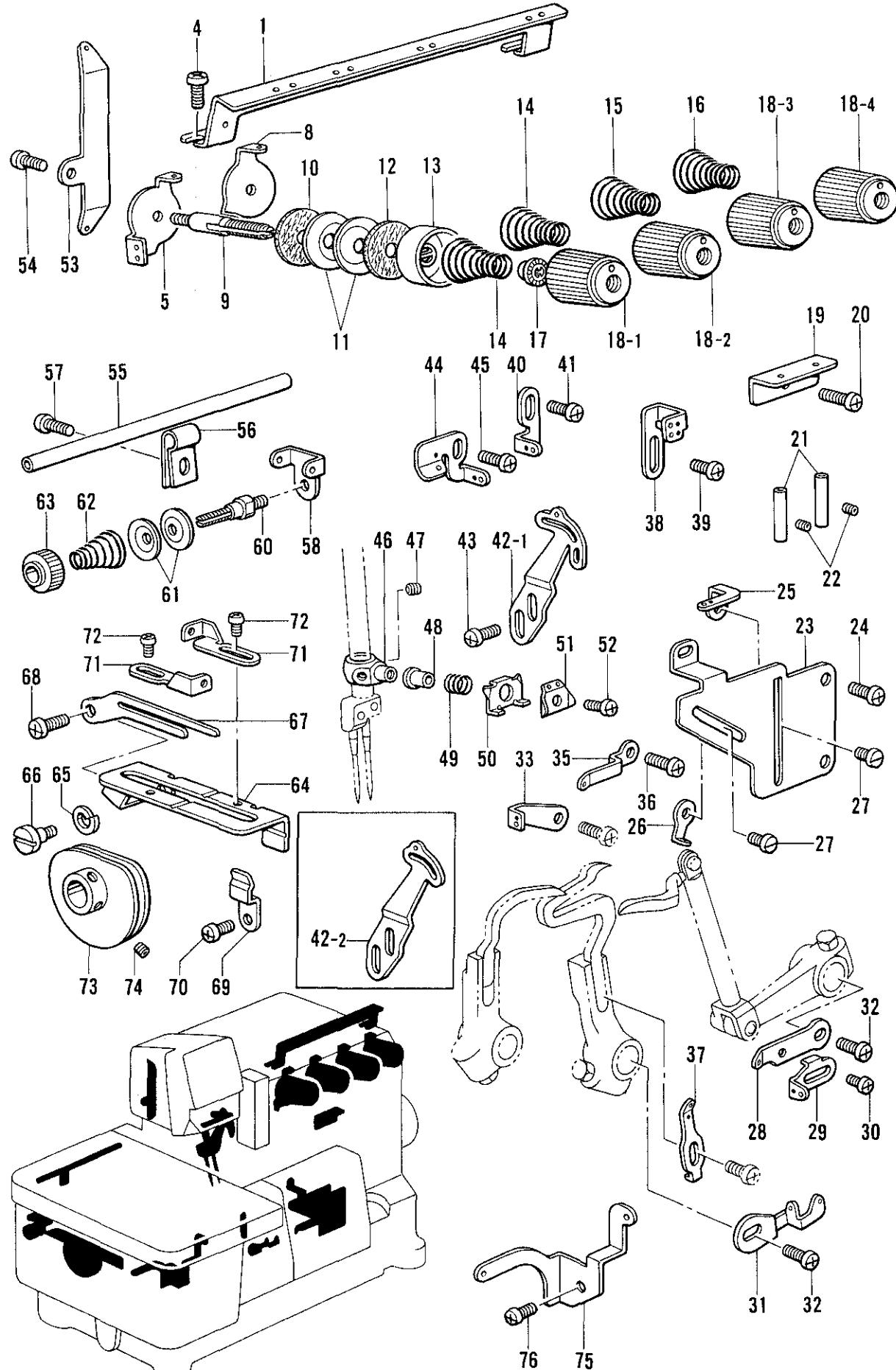
N. 糸調子関係/Thread tension/Faderspannung/
